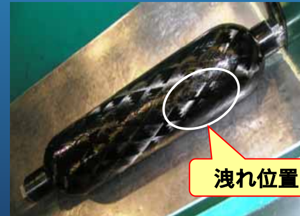
常温サイクル試験後タンク
